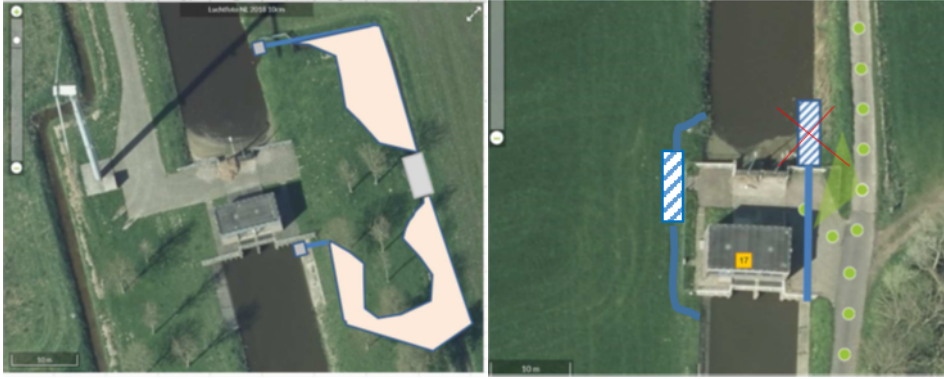
Figuur 2. Uit te werken varianten voor gemalen Sichterman (links) en gemaal de Delthe (rechts). Een vispassage in het natte profiel wordt hier afgeraden (rood kruis)
